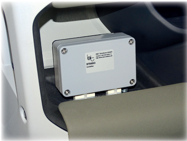
Einbaubeispiel: Land Rover Defender Ausgabe der Signale Zündung, Hecktüre und Motorlauf.
